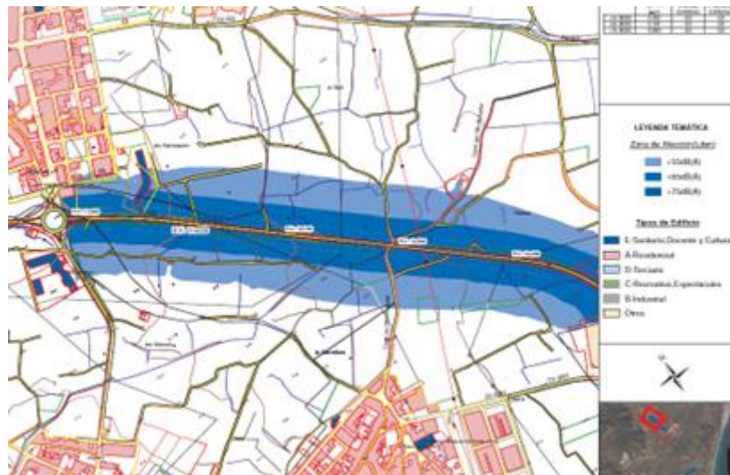
Figura 36: Zones amb afectació acústica de la cv-320. Font: Sistemes per a la Informació de la Contaminació Acústica.
